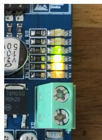
Beim betätigen der entsprechenden Eingänge für Air, Coolant oder FAST Pump, sollten nun die Relais schalten und der Motor sich kontinuierlich in eine Richtung drehen. (gegebenenfalls den Motor umpolen)
