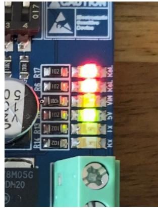
Der Schaltzustand der Relais wird über jeweils eine rote LED angezeigt.
